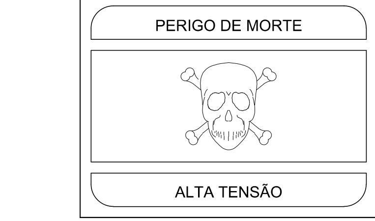
8 DETALHE - PLACA DE ADVERTÊNCIA - PL ESCALA: SEM
